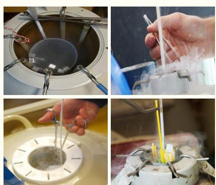
Извлекайте одну соломинку за один раз. Если процесс извлечения занял больше 10 секунд, опустите канистру со стаканом семени обратно в жидкий азот и подождите 20-30 секунд для охлаждения.
